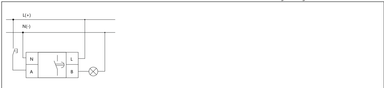
Imagen 2 Diagrama de cableado del relé NTE8-□A
