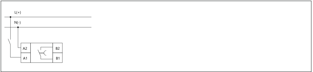
Imagen 3 Diagrama de cableado del relé NTE8-□B
